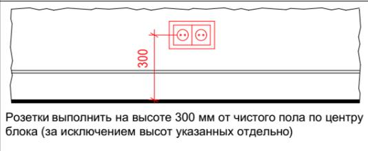
Розетки выполнить на высоте 300 мм от чистого пола по центру блока (за исключением высот указанных отдельно)
