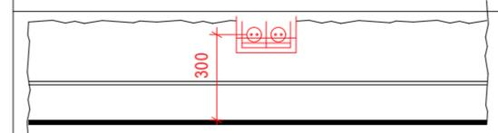
Розетки выполнять на высоте 300 мм от чистого пола по центру блока (за исключением высот указанных отдельно)
