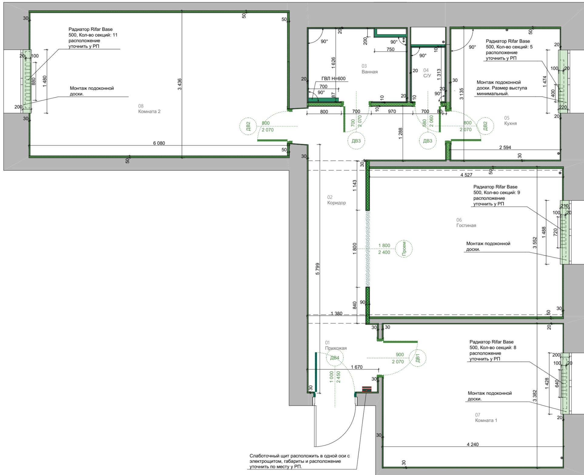
Слаботочный щит расположить в одной оси с электрощитом, габариты и расположение уточнить по месту у РП.
